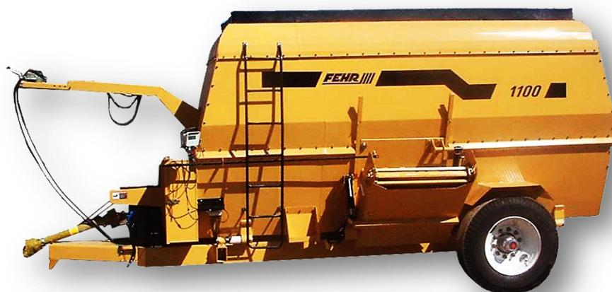
El sistema utilizado es hidráulico, el aceite que se usa es el mismo del tractor, además consta de un motor hidráulico que hace girar la banda de descarga.
