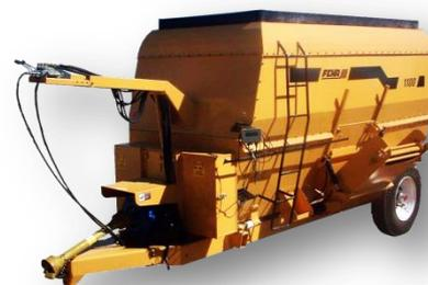
El mezclador tiene un control de palancas situado en el ganso para activar la descarga y la distribución del forraje de la tolva, hay que maniobrar una palanca para abrir la puerta, otra para darle el giro a la banda cuando se vaya a depositar el forraje en los comederos y otra para bajar o subir la banda.
